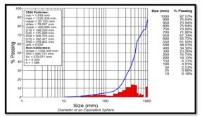
Fig. 12 Analysed Blast Muckpile
